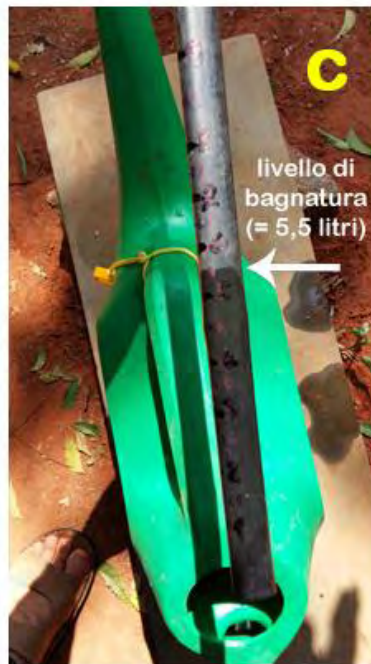
Foto 27- a) Innaffiatoio da 10 litri. b-c) Barra graduata per la misurazione dei volumi di irrigazione (litri).
